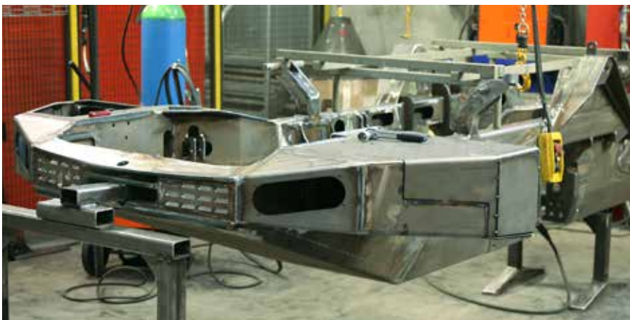
Taivutettuja osia metsäkoneen alustaan 6-16 mm Weldom 700 E -suurlujuusteräksestä.
