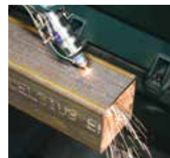
3D-leikkaus, jossa leikkauspinta on halutussa kulmassa
