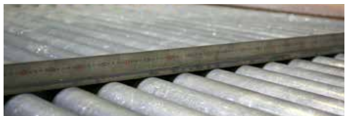
Teräslevy oikaisun jälkeen
