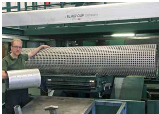
3D-leikkaus, jossa leikkauspinta on halutussa kulmassa
