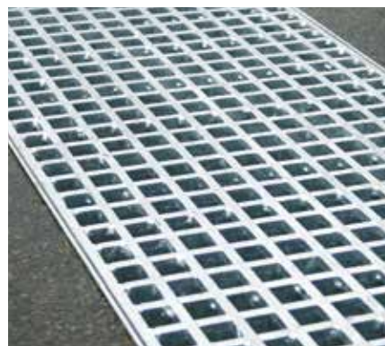
A-ritilä äärimmäisille kuormille. Kantoteräkset 40x10 mm lattaterästä 40 mm välein, sideteräkset 10x10 mm neliöprofiilia 40 mm välein.
